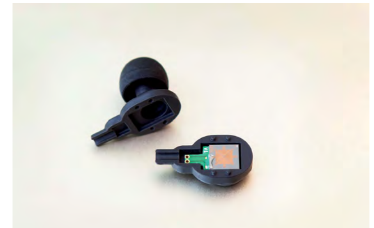
MEMS-Lautsprecher-Chip, eingebettet in ein in-ear-Kopfhörergehäuse.
